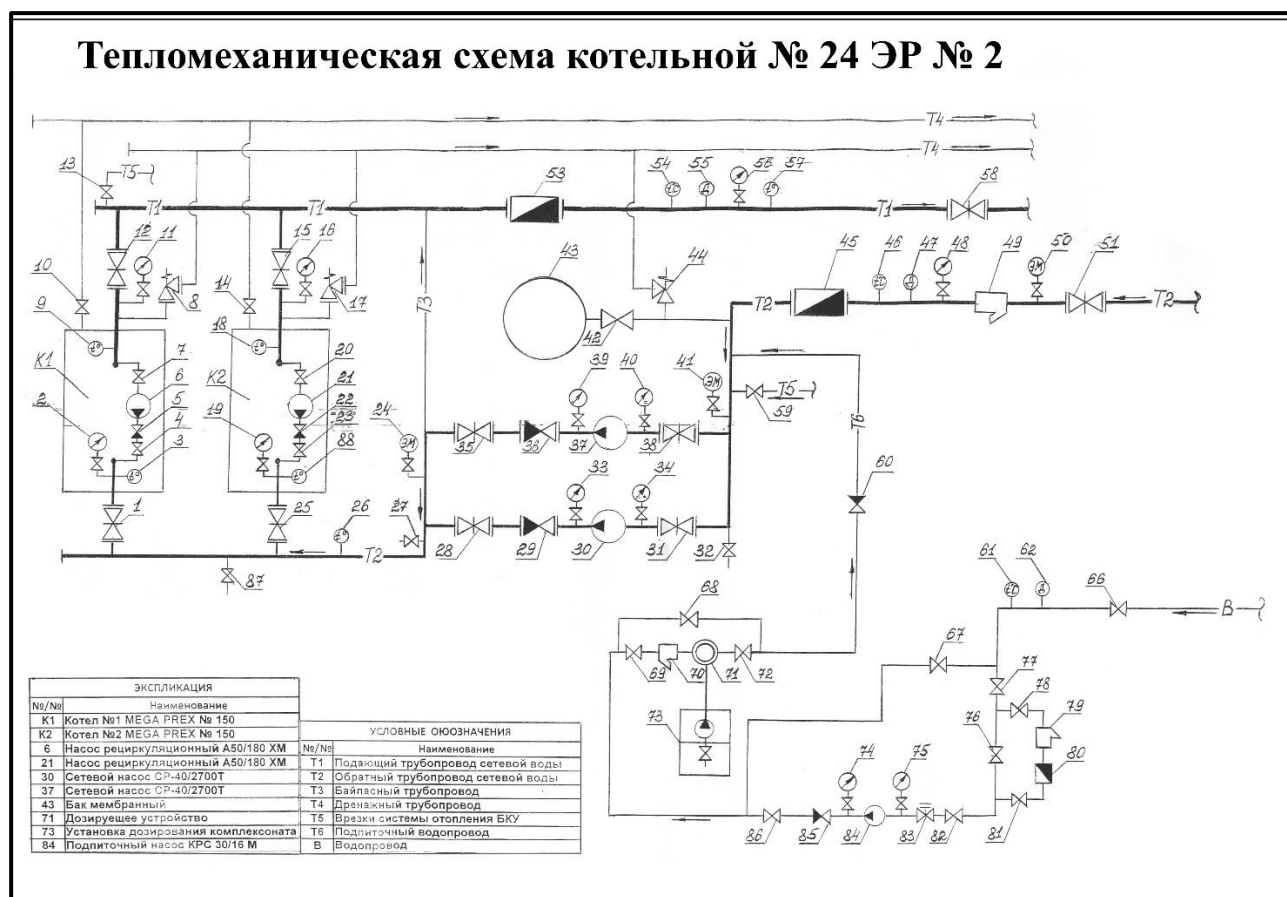
Рисунок 1.2.6.2 – Тепломеханическая схема котельной №24
